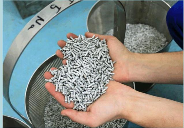
Beim Trommelanodisieren werden die Teile direkt als Schüttgut behandelt
