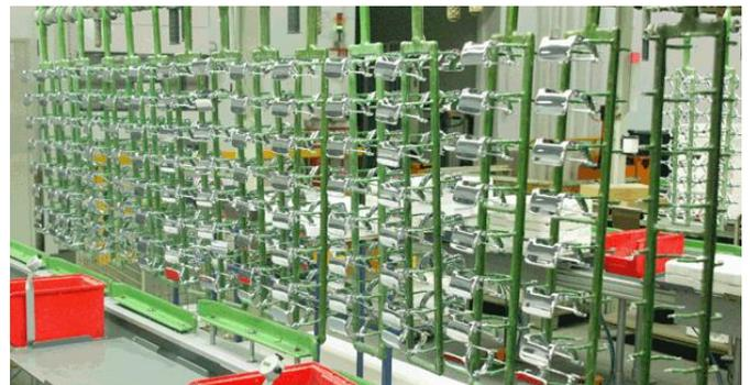
Bei den üblichen galvanischen Beschichtungsverfahren müssen die Teile von Hand einzeln auf spezielle Kontaktiergestelle gehängt bzw. gesteckt werden
