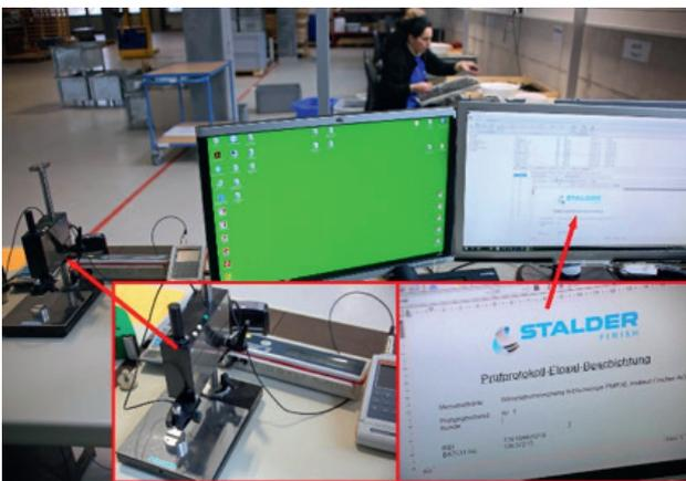
Vorne eine computergestützte Schichtdicken-Prüfanlage, im Hintergrund Mitarbeiter bei der manuellen 100%-Sichtprüfung beschichteter Teile (Foto: Klaus Vollrath)
